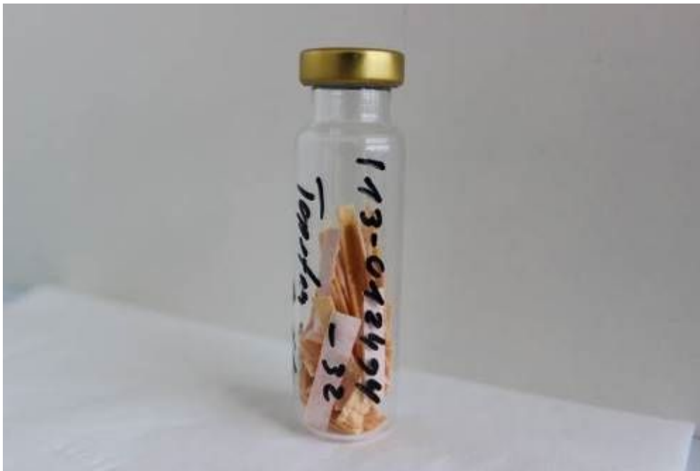
Material zerkleinert in Röhrchen zur Headspace Analytik; Foto Labor Friedle GmbH
