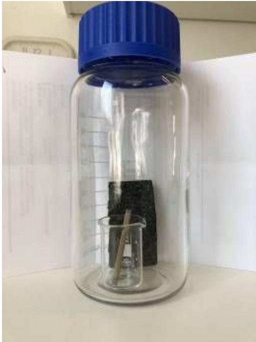
Exsikkator mit TENAX Passivsammler und Materialprobe, Foto Analytik Aurachtal GmbH
