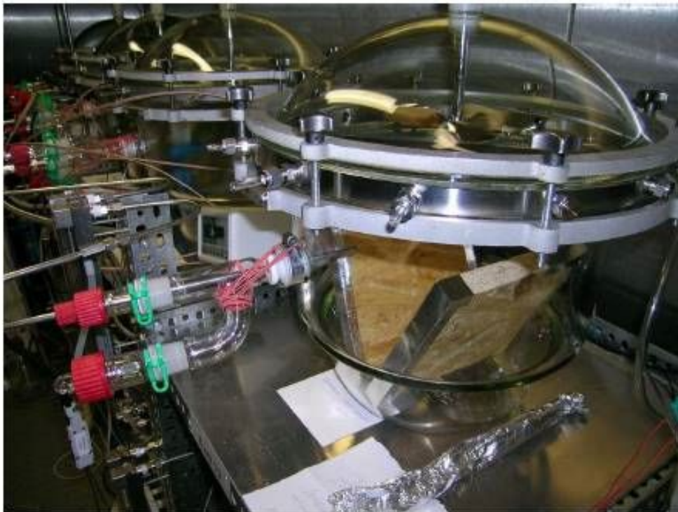
24 | Emissionsprüfkammer, Foto UBA Emissionsverhalten von Holzwerkstoffen 07/2012
