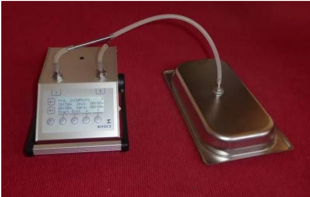
Modifizierte FLEC-Messzelle zur Beprobung des Teppichbodens
