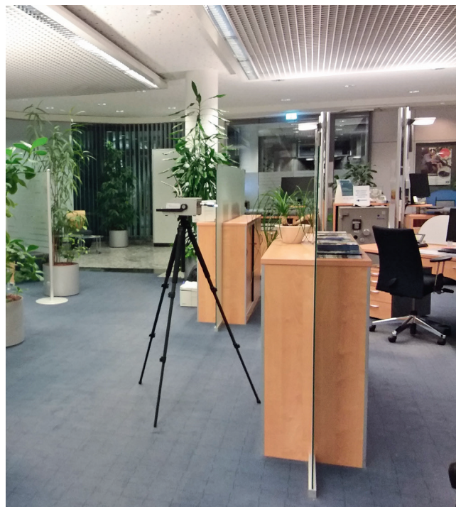
Abb. 13: Luftprobenahme auf TENAX (Adsorbermaterial bei Luftuntersuchungen) im Schalterraum der Bank
