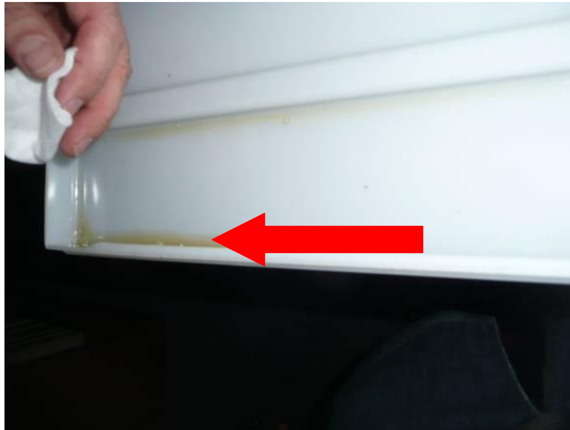
PCB-haltige Kondensatorflüssigkeit im Lampenschirm
